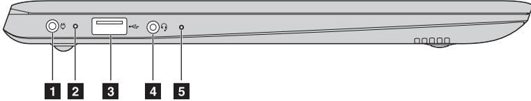
**1** 交流电源适配器插孔 连接交流电源适配器。
