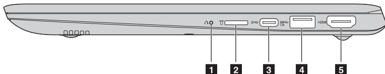
**1 Novo 按钮** 计算机处于关机状态时，按此按钮打开系统恢复或 BIOS 设置程序，或者进入启动菜单。
